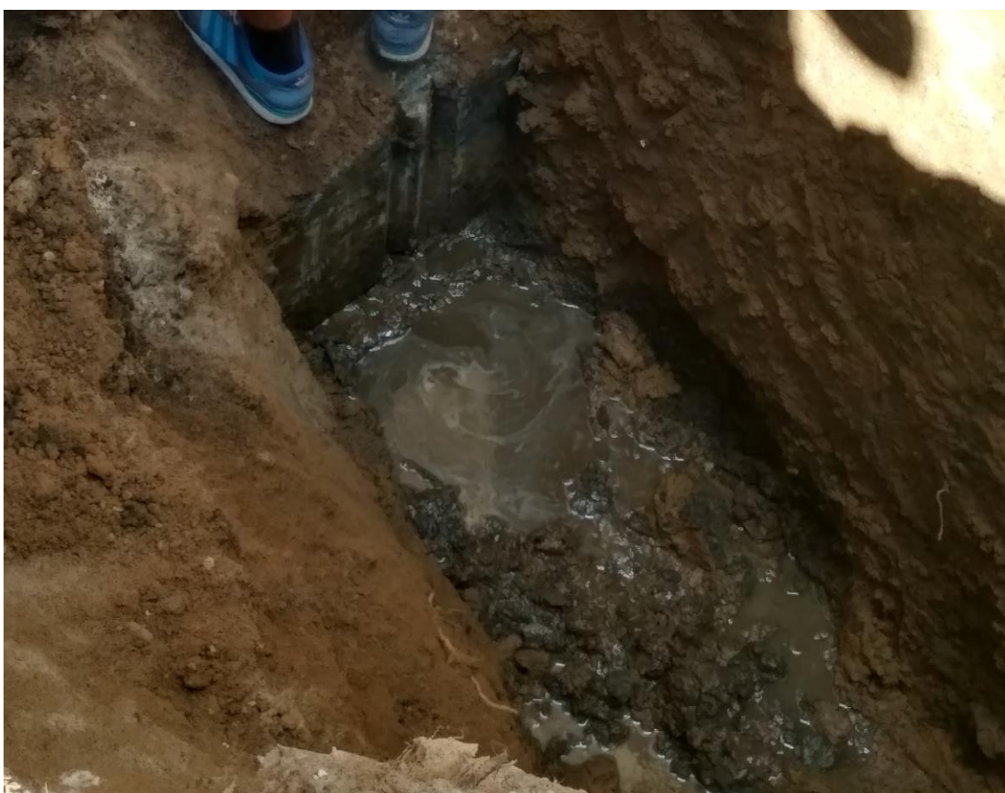
Фото 16 – Скопление воды в шурфе №2.
